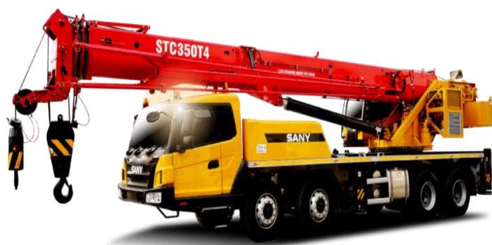
รูปที่ 2 รถปั้นจั่นขนาดไม่เกิน 50 ตัน (บริษัท แม็กซ์คอน แมชชีนเนอร์ จำกัด, 2561ข)
