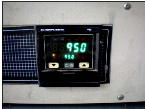
รูปที่ 3 แสดงอุณหภูมิที่ใช้อบชุบชิ้นทดสอบ
