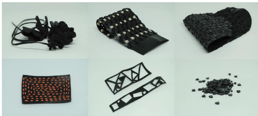
รูปที่ 7 การทดลองเทคนิคการทำ และหาคุณสมบัติของวัสดุยางรถ
