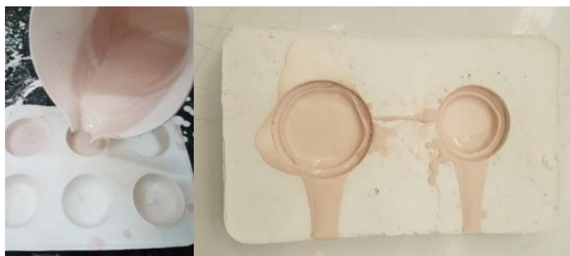
ภาพที่ 19 แสดงการหล่อและเทน้ำดินส่วนเกินออก
