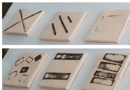
ภาพที่ 8 แสดงชิ้นงานการทดลองหลังเผาที่อุณหภูมิ 900 องศา
