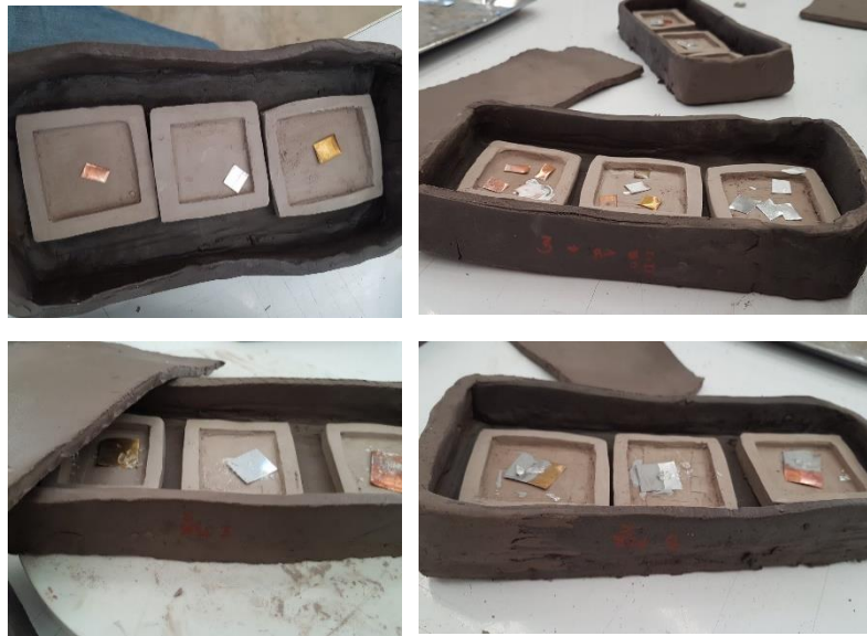
ภาพที่ 5 แสดงชิ้นงานเผาแก้ก่อนนำเข้าเตาเผาที่อุณหภูมิ 1200 องศา
