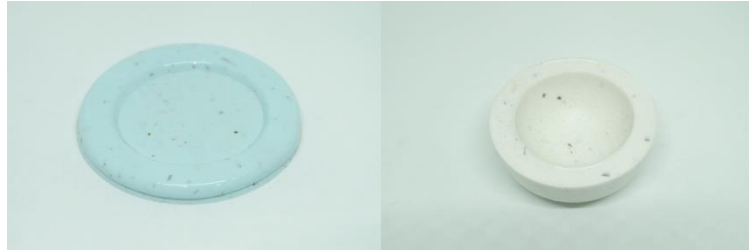
รูปที่ 11 อุปกรณ์บน โต๊ะทำจากยางซิลิโคนผสมกับยางรถสำหรับจัดเก็บสิ่งของต่างๆ
