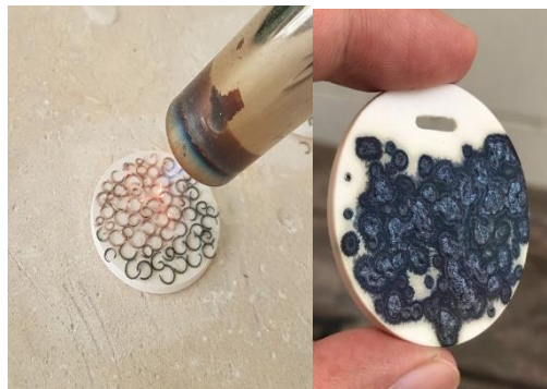
ภาพที่ 24 แสดงการเผาชิ้นงานด้วยแก๊สกระป๋อง
