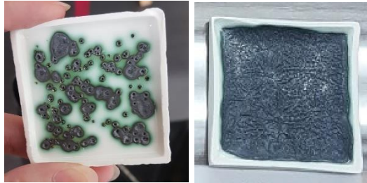
ภาพที่ 15 แสดงชิ้นงาน หลังเผาที่อุณหภูมิ 1200 องศา
