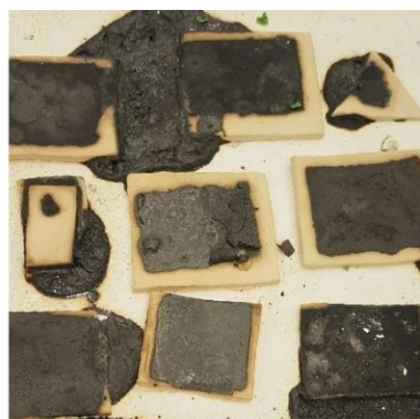
ภาพที่ 4 แสดงชิ้นงานหลังการเผาอุณหภูมิ 1200 องศา
