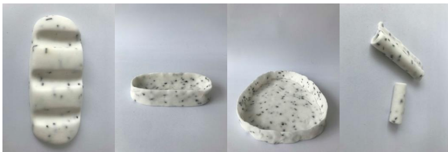
รูปที่ 5 การทดลองการสร้างชิ้นงานซิลิโคนยาแนวที่เกิดจากการผสมซิลิโคนร่วมกับแป้งข้าวโพด
