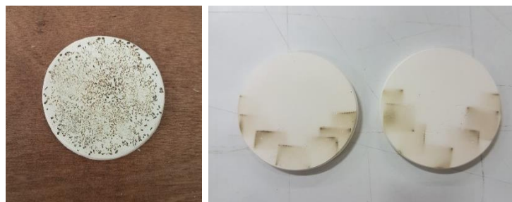
ภาพที่ 11 แสดงชิ้นงานหลังเผาที่อุณหภูมิ 900 องศา
