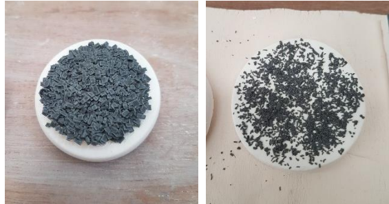
ภาพที่ 12 แสดงชิ้นงานหลังเผาที่อุณหภูมิ 900 องศา
