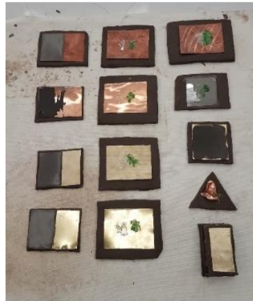
ภาพที่ 3 แสดงชิ้นงานก่อนนำเข้าเตาเผาที่อุณหภูมิ 1200 องศา
