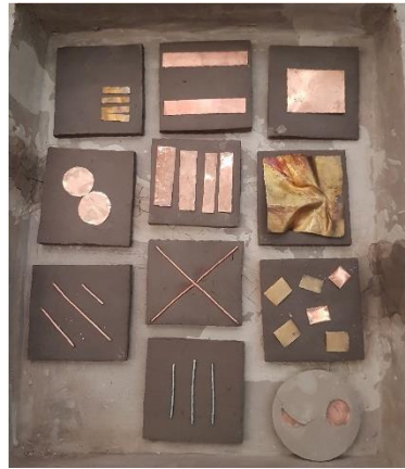
ภาพที่ 7 แสดงการทดลองตัดโลหะทองแดงเป็นรูปทรงอื่นๆ และเผาที่อุณหภูมิ 900 องศา
