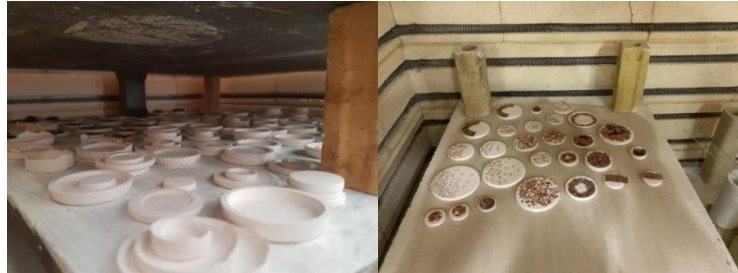
ภาพที่ 23 แสดงการนำชิ้นงานเข้าเตา
