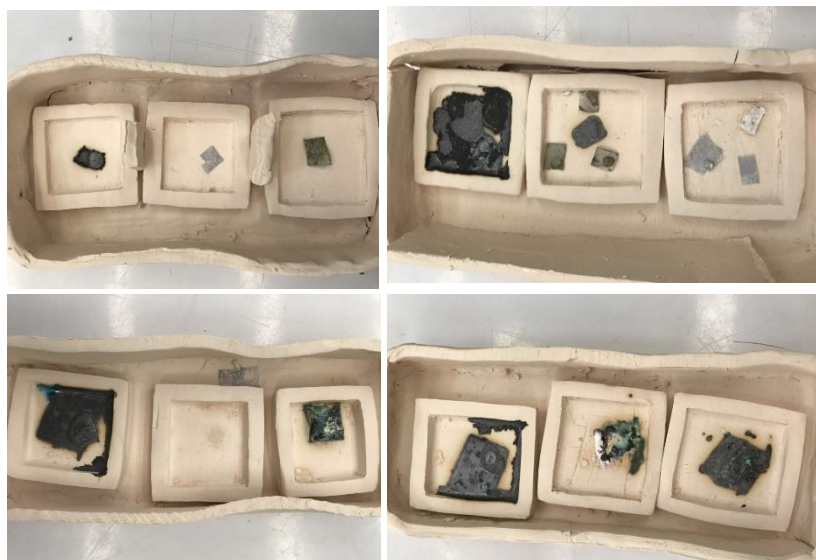
ภาพที่ 6 แสดงชิ้นงานหลังการเผาแก้ที่อุณหภูมิ 1200 องศา
