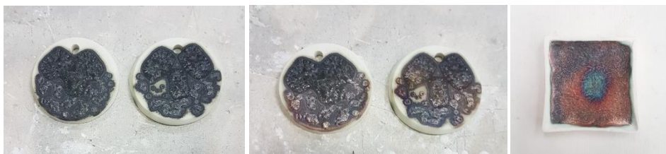
ภาพที่ 16 แสดงชิ้นงาน ก่อน-หลังให้ความร้อนด้วยแก๊สกระป๋อง ที่อุณหภูมิ 1200 องศา
