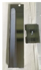
รูปที่ 2 เครื่องวัดค่าความละเอียดอนุภาคหมึกพิมพ์ (grind-o-meter)
