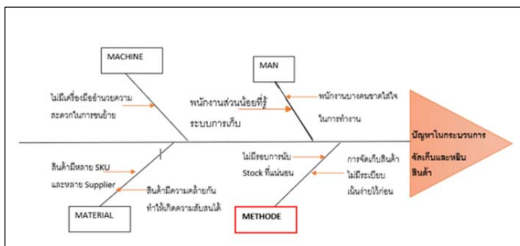
ภาพที่ 2 แผนผังก้างปลาของปัญหากระบวนการจัดเก็บและหยิบสินค้า
