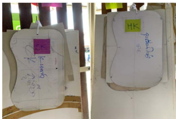
ภาพที่ 6 แสดงการนำหลักการควบคุมด้วยการมองเห็น หรือ Visual Controls มาใช้
