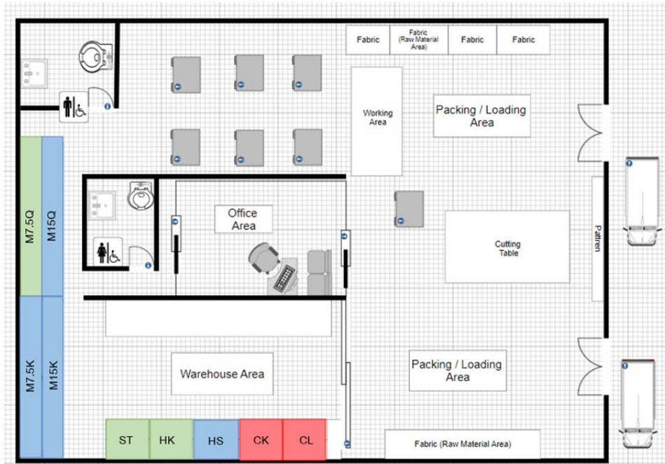
ภาพที่ 4 แสดงการจัดวางสินค้ารูปแบบใหม่
