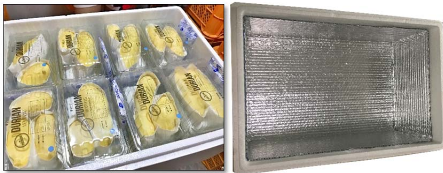
ภาพที่ 7 การแพ็คสินค้าแบบเดิมและการแพ็คโดยการนำฉนวนกันความร้อนเข้ามาปรับใช้
