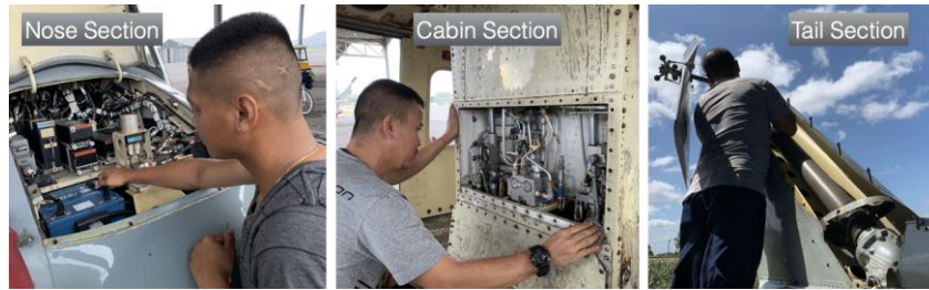
รูปที่ 2 แสดงการตรวจในหัวข้อ Visual Insp ในตำแหน่งต่าง ๆ ของอากาศยาน
