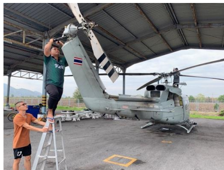
รูปที่ 3 การอัด ไขพร้อมกันทั้งสองส่วนของ Transmission Section และ Tail Section
