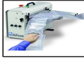
รูปที่ 3 แสดงเครื่องผลิต Air pouch
