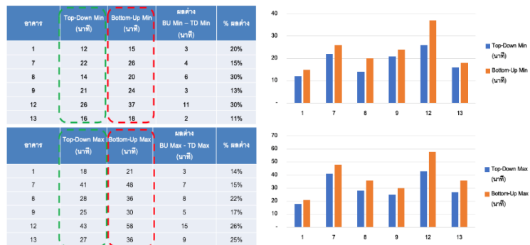
ภาพที่ 6 ข้อมูลเปรียบเทียบเวลาการใช้ลิฟต์ในการกระจายระหว่างรูปแบบ Top-Down และแบบ Bottom-Up
