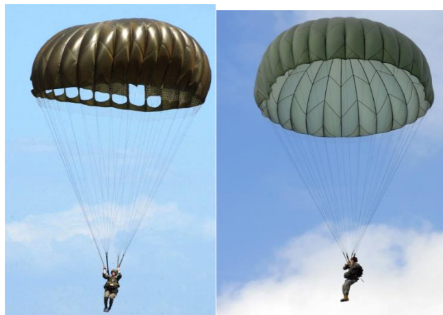
รูปที่ 2 ร่มบุคคลกระโดด MC1-C รูปซ้ายเป็นร่มหลัก รูปขวาเป็นร่มช่วย
