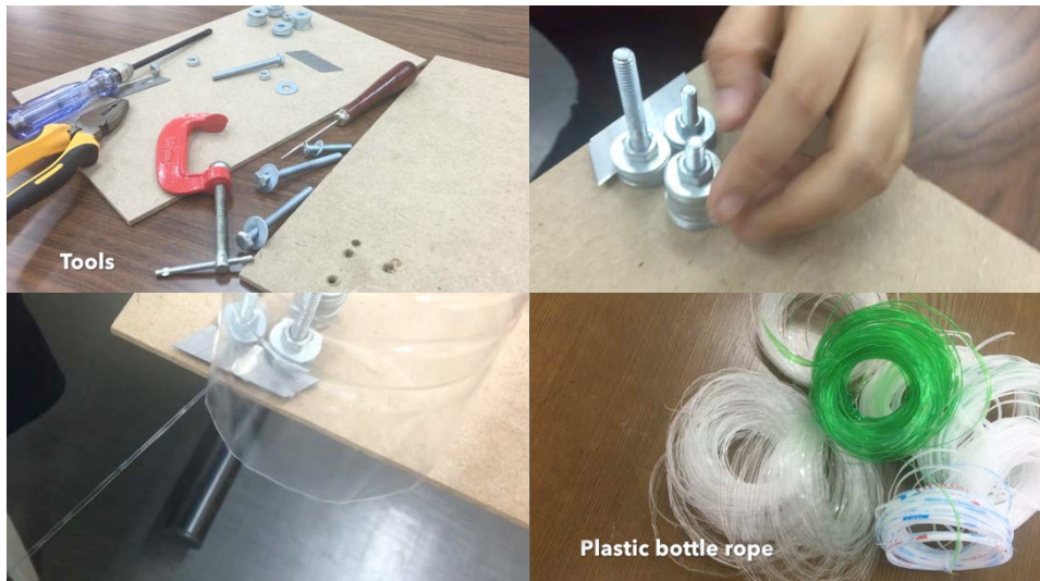
รูปที่ 3 ภาพการสร้างอุปกรณ์ในการเปลี่ยนแปลงขวดพลาสติก
