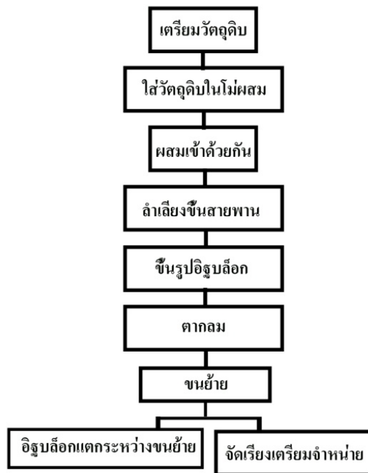
ภาพแผนผังแสดงลำดับขั้นตอนการผลิตอิฐบล็อก
