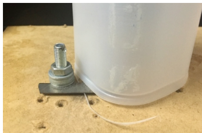
รูปที่ 2 ขั้นตอนตัดเส้นด้วยอุปกรณ์ตัดเส้นพลาสติก
