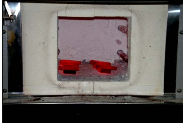
รูปที่ 4 การปล่อยให้ชิ้นทดสอบที่ผ่านการอบเย็นลงภายในเตา
