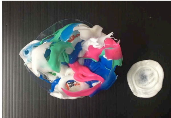
รูปที่ 5 ภาพขวดพลาสติกจากขบวนการประเภท HDPE ที่ได้รับความร้อนจากเครื่องเป่าลมร้อน และเตารีด
