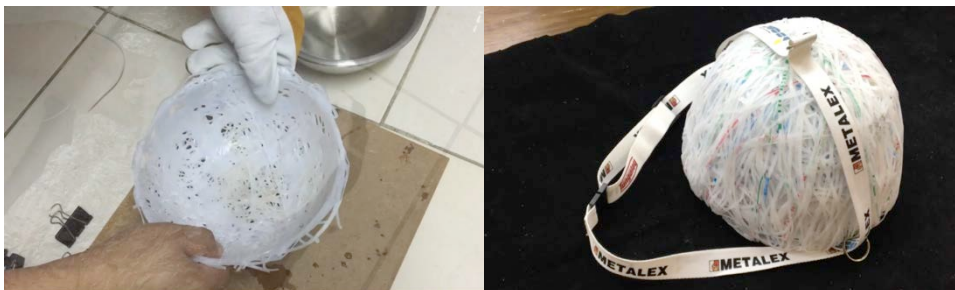
รูปที่ 6 ผลิตภัณฑ์หมวกจากเส้นพลาสติกที่ขึ้นรูปด้วยภาชนะสแตนเลส
