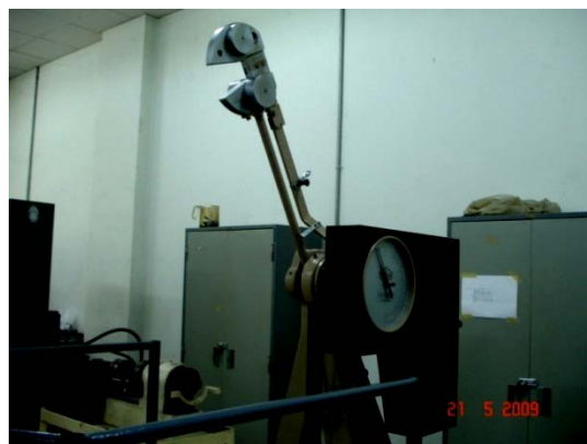
รูปที่ 5 แสดงระดับการยกค้อนในท่าเตรียมทดสอบ
