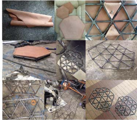
รูปที่ 12 การผลิตชุดเก้าอี้โยก ส่วนโครง เบาะ และยางกันลื่นที่ส่วนฐาน
