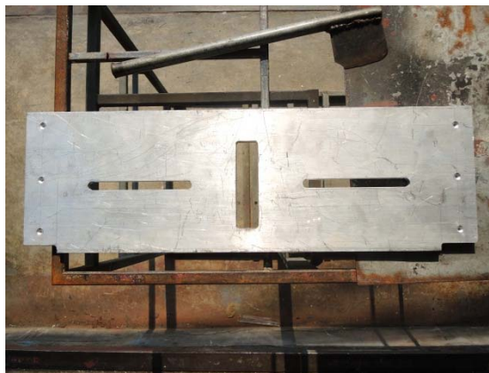
รูปที่ 5 ฐานอลูมิเนียมสำหรับใส่วงล้อทั้ง 2 วง
