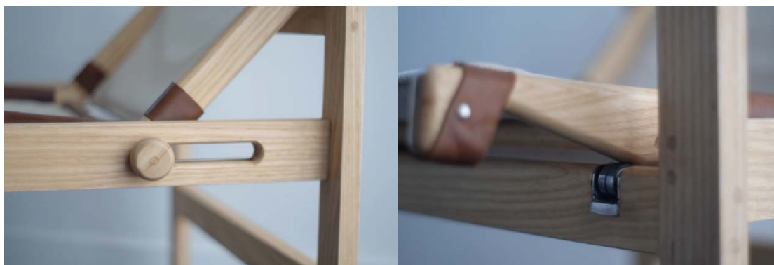
รูปที่ 10 ภาพระบบการทำงานแบบง่ายของเก้าอี้
