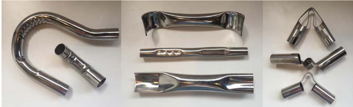
รอยย่น ที่เกิดจากเครื่องตัดท่อ โค้ง
