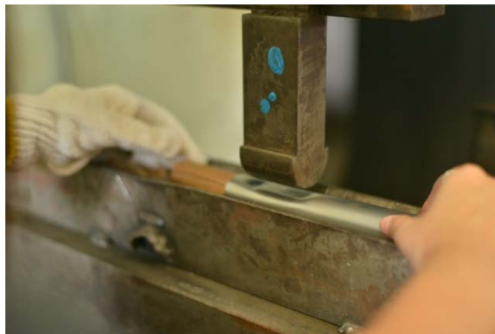
รูปที่ 11 การกดทอสแตนเลสเข้ากับไม้
