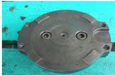
รูปที่ 5 แสดงฐานรองอุปกรณ์จับยึดชิ้นงาน
