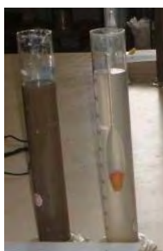
รูปที่ 4 การทดสอบไฮโดรมิเตอร์เพื่อหาขนาดอนุภาคดิน และการหาขนาดอนุภาคเฉลี่ย D_{50}
