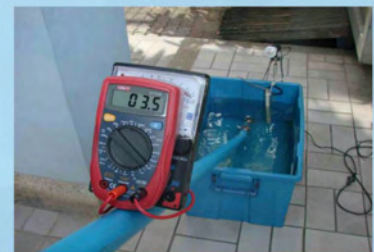
การนำโวลต์มิเตอร์วัดแรงดันไฟฟ้าที่รั่ว
