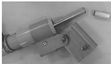
รูปที่ 13 ชุดอุปกรณ์จับยึดตัวอย่าง และตัวอย่างเตรียมทดสอบ
