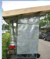
ห้องอบไม้พลังงานแสงอาทิตย์
