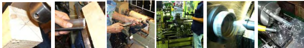
ภาพที่ 11 วิธีการผลิตกระปุกไม้ยางพาราและกระปุกสแตนเลส ด้วยวิธีการกลึง ที่มา : นายอนุพงศ์ สุทธะลักษณ์ , 11 เมษายน 2556
