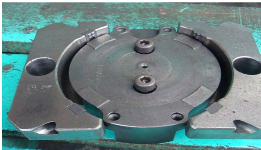
รูปที่ 6 แสดงอุปกรณ์จับยึดชิ้นงาน
