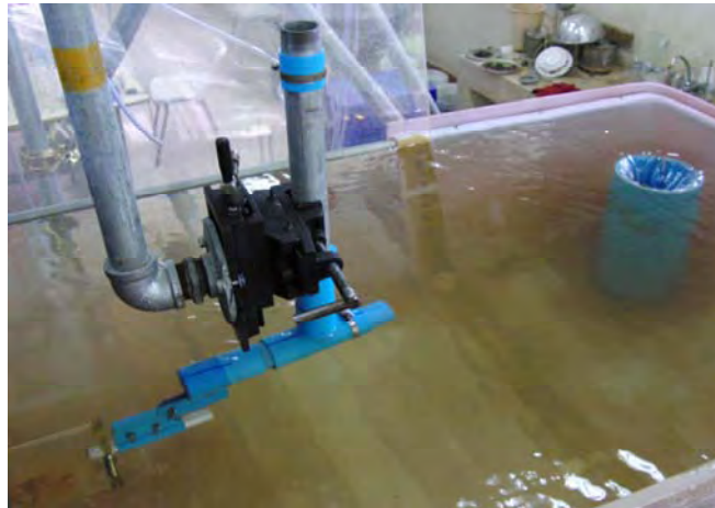
รูปที่ 17 การทดสอบหาความเร็วลำน้ำกักเซาะวิกฤตในท่อใต้ผิวน้ำ
