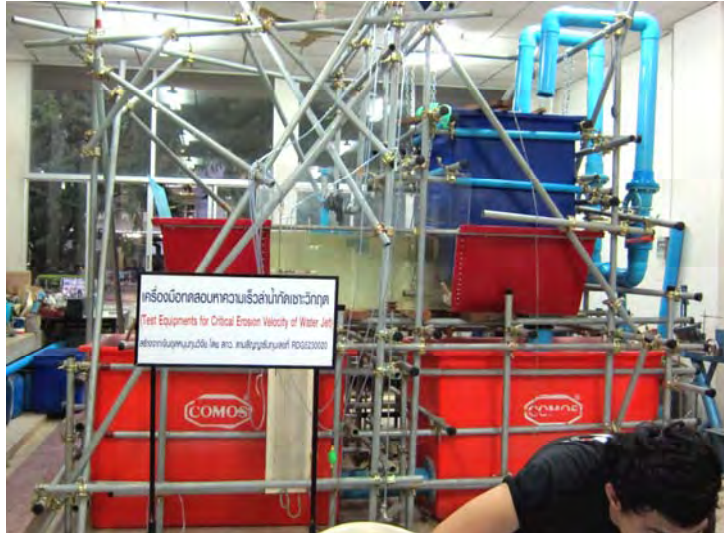
รูปที่ 15 ชุดอุปกรณ์หาความเร็วลำน้ำกัดเซาะวิกฤต
