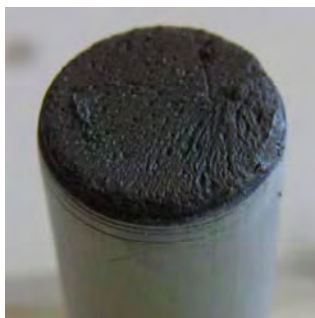
รูปที่ 16 การดันตัวอย่างดินให้ผ่านขอบกระบอกโลหะ
