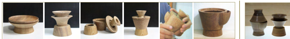
รูปที่ 6 (ซ้าย) การทดลองกลึงขึ้นรูปด้วยไม้สัก
