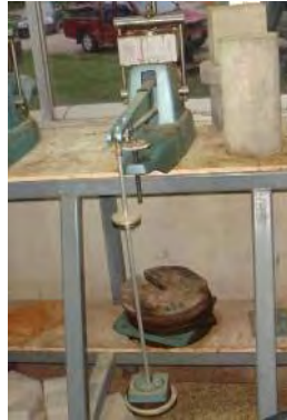
รูปที่ 5 การทดสอบการยุบอัดตัวของดิน เพื่อหาอัตราส่วนช่องว่าง
