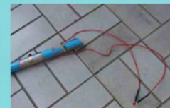
รูปที่ 3 ประกอบแผ่นอลูมิเนียมกับท่อ PVC และสายไฟ
