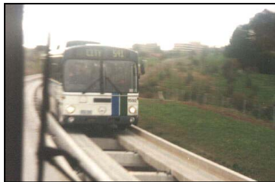
รูปที่ 3.2 ตัวอย่างระบบรถโดยสารนำทางโดยขอบทาง
