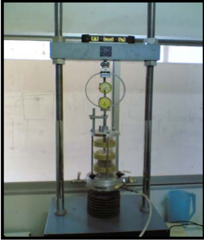
รูปที่ 1 เครื่องมือทดสอบแรงอัดสามแกน
