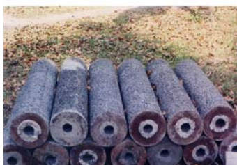
รูปที่ 3 แสดงเสาเข็มพูน
